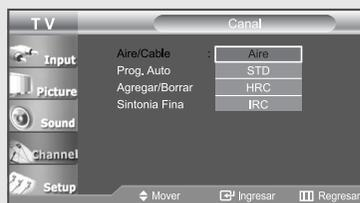
Nota: STD, HRC e IRC identifican los distintos tipos de sistemas de TV por cable.
