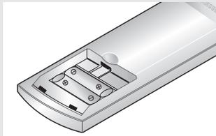
◀ Compruebe que los extremos “+” y “-” de las pilas concuerdan con el diagrama del interior del compartimento.
