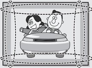
Aunque la difusión digital debe realizarse en el formato HD de pantalla ancha (16:9), las empresas de televisión transmiten a veces programas hechos originalmente en el formato de pantalla regular (4:3) convirtiendo las señales a formato digital, en cuyo caso se recortan los bordes laterales izquierdo y derecho de la pantalla.
